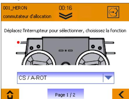
Pour attribuer une autre fonction à l'interrupteur sélectionné, il faut, dans un premier temps, le basculer pour le changer de position. L'interrupteur ainsi reconnu, sera marqué ensuite d'un point rouge, sa fonction actuelle sera affichée dans la liste Drop-Down. La nouvelle fonction pourra alors être sélectionnée en cliquant sur une des fonctions de la liste.
