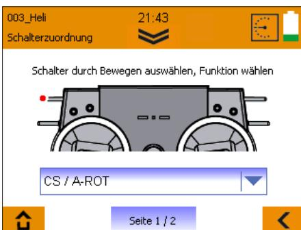
Um den gewünschten Schalter mit einer anderen Funktion zu belegen, muss dieser zunächst bewegt werden.
