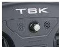
Le potentiomètre peut être programmé pour de nombreuses fonctions. Un haut-parleur diffuse des alertes et des notifications lors de l'utilisation des menus de programmation.
